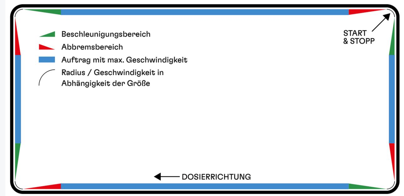
**Auftragsgeschwindigkeit von 44 m/min
