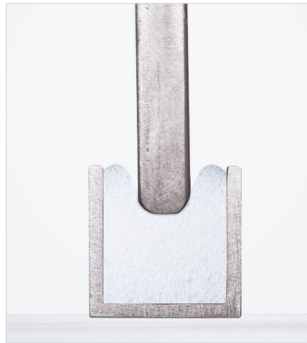
Querschnitt Silikonschaumraupe in Nut zu ca. 30 % verpresst
