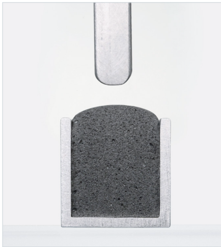
Querschnitt Polyurethanschaumraupe in Nut unverpresst
