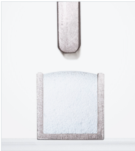
Querschnitt Silikonschaumraupe in Nut unverpresst
