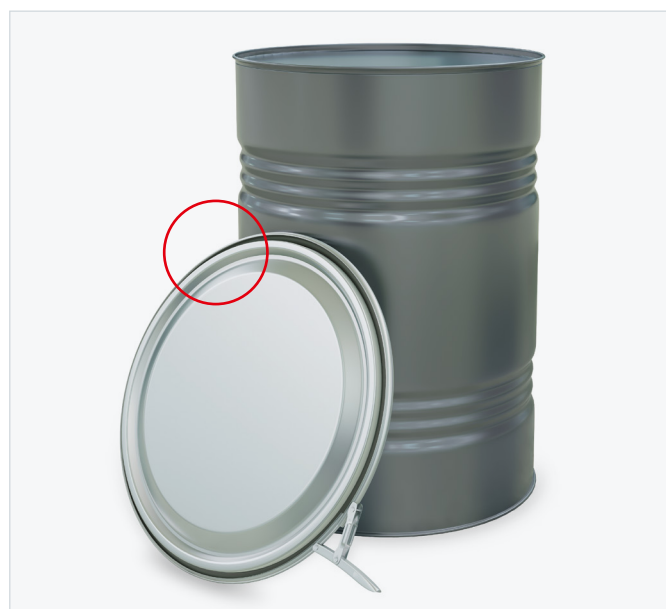
Metallfass mit PU-Schaumdichtung im Deckel und Spannring, für häufiges Öffnen und Wiederschließen dank Schaumdichtung mit gleichbleibender Dichtwirkung
