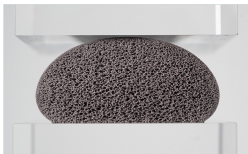
Die unverpresste Polyurethan-Schaumdichtung vor dem Einbau.
