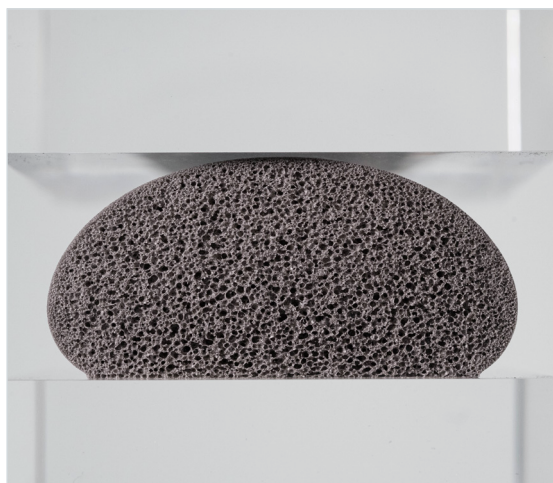
Querschnitt Polyurethanschaumraupe unverpresst
