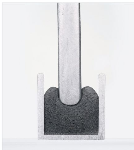
Querschnitt Polyurethanschaumraupe in Nut zu ca. 50 % verpresst
