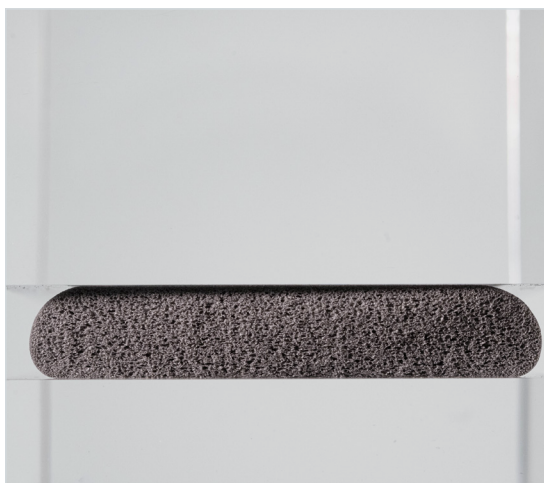
Querschnitt Polyurethanschaumraupe zu 50 % verspresst
