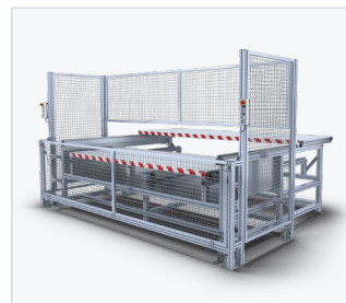
Optional: Wechsel-/Schiebetisch WT 2-LEVEL mit zwei im Pendelbetrieb arbeitende Aufnahmeplatten in zwei Ebenen
