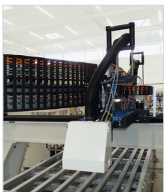
Primerauftragseinheit – die optional auf der Rückseite der CNC-Y-Achse montierte Primerdüse trägt parallel zum Dichtungsauftrag auf pulverbeschichteten oder Edelstahl-Oberflächen in derselben Kontur den Primer auf.
