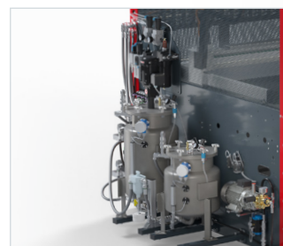
Die Materialdruckbehälter , mit 44 l Fassungsvermögen für die A-Komponente und 24 l für die B-Komponente, nehmen das typische, asymmetrische Mischungsverhältnis auf, das stufenlos von 10 : 1 bis 1 : 2 eingestellt werden kann
