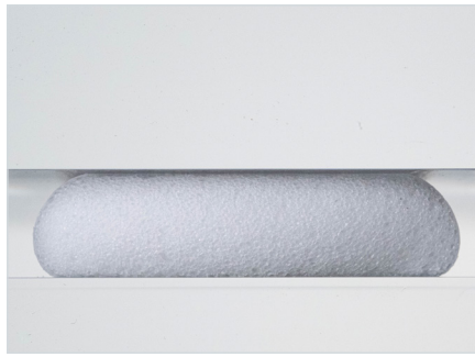
Querschnitt Silikonschaumraupe zu 30 % verpresst
