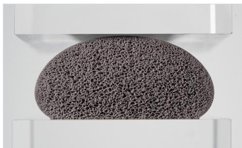
Die unverpresste Polyurethan-Schaumdichtung vor dem Einbau.
