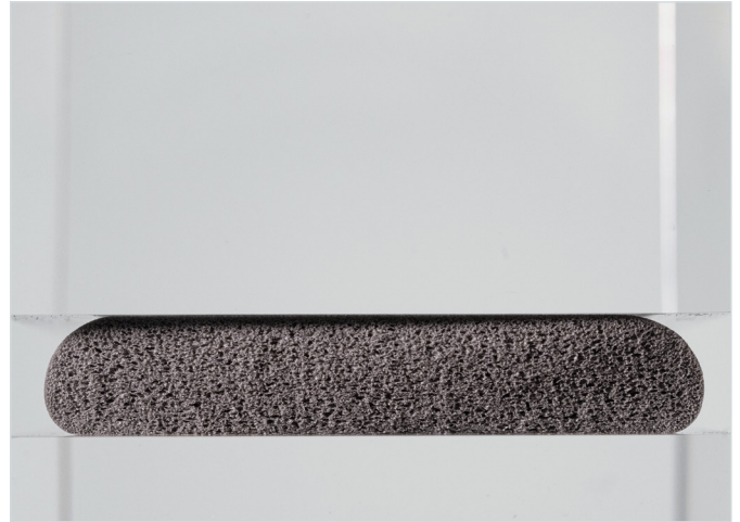
Querschnitt Polyurethanschaumraupe zu 50 % verpresst
