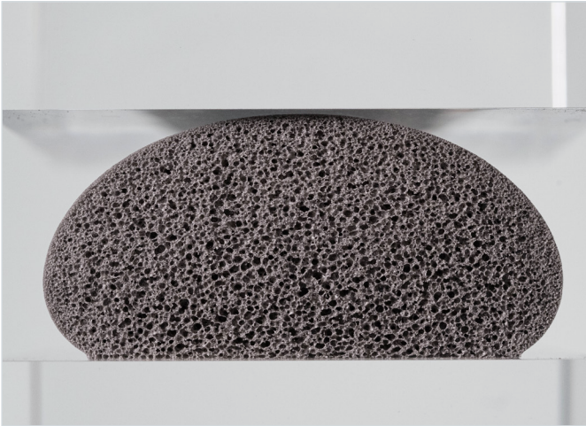
Querschnitt Polyurethanschaumraupe unverpresst
