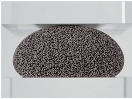
Querschnitt Polyurethanschaumraupe unverpresst
