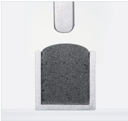
Querschnitt Polyurethanschaumraupe in Nut unverpresst
