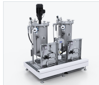
Separat stehende Materialdruckbehälter (24 l oder 44 l, einwandig oder doppelwandig) mit Minimum-Füllstandssensoren, auf Gitterrostpodest mit einstellbaren Nivellierfüßen und Auffangwanne
