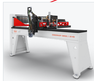
Hochdynamischer 3-Achs-Linearroboter LR-HD für die präzise Führung von Mischköpfen zum Auftrag polymerer Reaktionswerkstoffe. Der Zahnstangenantrieb mit hoher Steifigkeit und Beschleunigung ermöglicht dynamische Auftragsgeschwindigkeiten.
