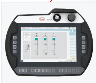
Das multifunktionale Mobile Panel MP 2 (10,1" WXGA TFT) ermöglicht eine komfortable Bedienung der Dosieranlage.
