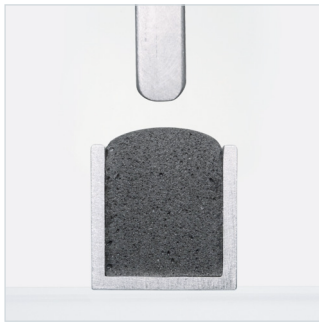
Querschnitt Polyurethanschaumraupe in Nut unverpresst
