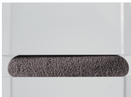
Querschnitt Polyurethanschaumraupe zu 50 % verpresst
