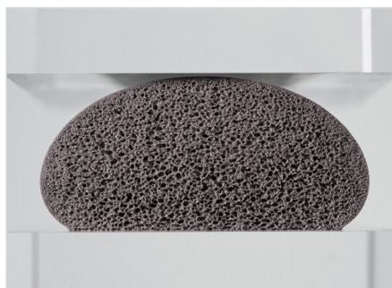
Querschnitt Polyurethanschaumraupe unverpresst
