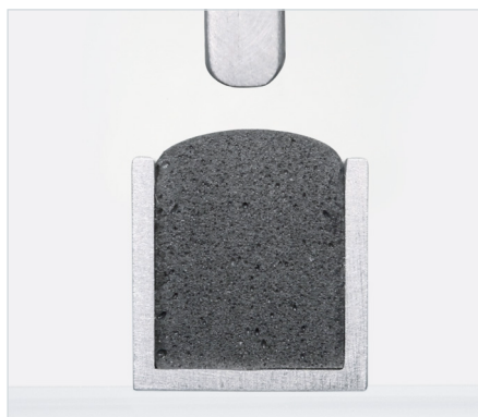
Querschnitt Polyurethanschaumraupe in Nut unverpresst
