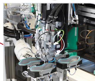
Der **6-Achs-Roboterarm** bewegt das Bauteil unterhalb des Mischkopfs für einen konturgenauen Dosierauftrag.
